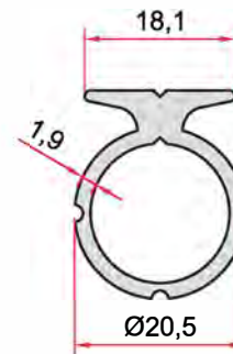
KOD-CODE TEORİK AĞIRLIK THEORETICAL WEIGHT EP-5082 0,418 Kg/m
