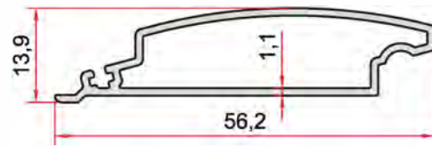
KOD-CODE TEORİK AĞIRLIK THEORETICAL WEIGHT EP-1015 0,365 Kg/m
