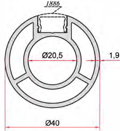
KOD-CODE TEORİK AĞIRLIK THEORETICAL WEIGHT EP-1990 1,047 Kg/m
