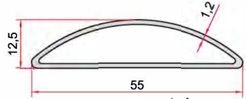
KOD-CODE TEORİK AĞIRLIK THEORETICAL WEIGHT EP-5058 0,371 Kg/m
